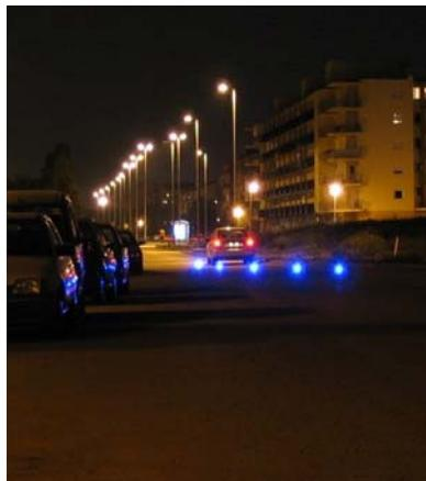
Sigurnosno svjetlo izvedeno pomoću svjetlećih dioda u vodonepropusnom robusnom kućištu malih dimenzija sa automatskim uključivanjem i punjenjem baterija pomoću bežičnog prijenosa energije.
