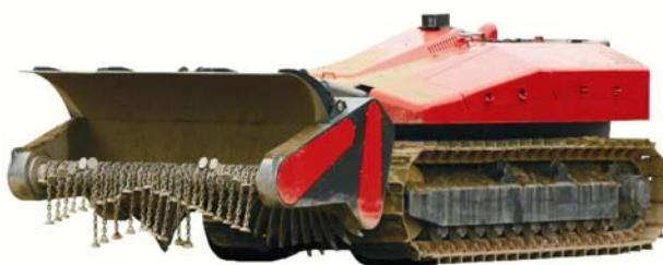
MV-10 stroj za razminiranje dvostruki alat mlatilica-freza, objedinjena prednost svakog od alata. U jednom prolazu se dvostruko tretira teren te je mogućnost zaostajanja aktivnih uboijitih sredstava minimalna.
