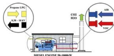
Novo tehnološko rješenje pretvara energetsku vrijednost otapala i otpadnih plinova i para direktno u radnu energiju u podešenim dizel motorima skopčanim sa generatorima električne energije 110/220 V uz iskorištenje energije iz otpadnog zraka iznad 80%. Ukravanjem nafte 10MGT godišnje u luci, po EPA/USA standardima izračunavanja, emisija ugljikovodika iz tankera ima energetsku vrijednost 4.000.000 kWh što pri cijeni 0,2 US \$ iznosi prihod 800.000 dolara godišnje.
