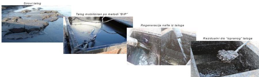
Prisutnost taloga na dnu spremnika za sirovu naftu nepoželjna je zbog brojnih operativnih problema. Stoga je talog potrebno fizički odstraniti iz spremnika, a zatim neutralizirati (prevesti u „bezopasni otpad“). U INI do sada nije postojao standardizirani način uklanjanja, dok se neutralizacija obavljala metodom „solidifikacije“ u za to posebno sagrađenim deponijama za otpadne fluide.
