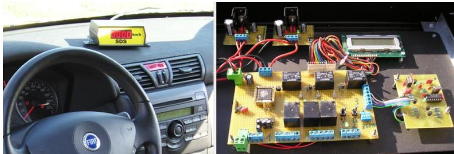
Uređaj je namijenjen za automatsko određivanje dozvoljene brzine vozila kod koje će se vozilo sigurno stići zaustaviti uzimajući u obzir vremenske uvijete, stanje kolnika i udaljenost od vozila ispred.
