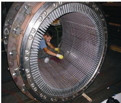
kamerom dolazi do zagrijavanja pojedinih polja što nije dozvoljeno jer bitno utječe na kara-kteristike stroja. Uređajem se djeluje tako da se oštećena polja tretiraju uz pomoć struje i elektrolita, čime dolazi do čišćenja takvih mesta. Površina polja se zaglađuje i pritom se povlače čestice koje uzrokuju kratki spoj između limova.
